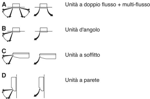
Per le condizioni seguenti, un microcomputer controlla la direzione del flusso d'aria che potrebbe essere differente da quella visualizzata.
